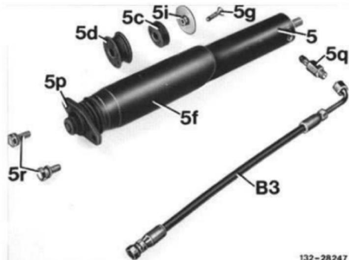
13 Federbein mit aufgeschobenem unteren Gummilager der oberen Aufhängung – abgeflachte Seite zum Federbein zeigend – einsetzen, dabei darauf achten, daß der Druckölanschluß zum Rahmen-Querträger zeigt und der Aufhängezapfen durch die Bohrung im Rahmen-Querträger ragt.
