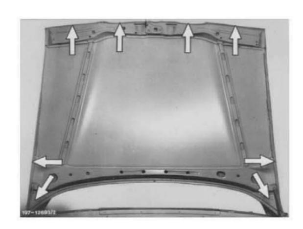
Punktschweißnaht am Vorderkotflügel unten
